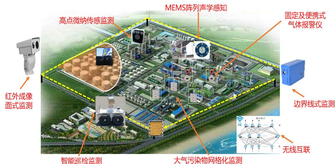
(a) 现场固定安装立体网格化泄漏与排放监测
